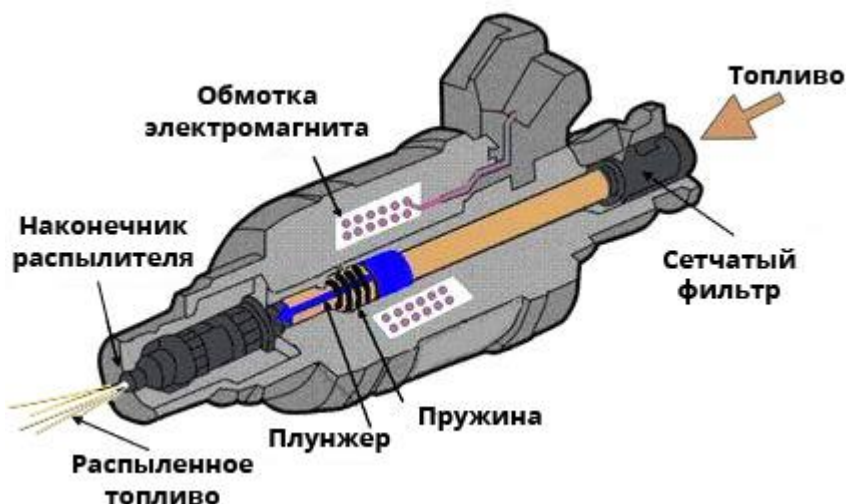
Рисунок 1. Устройство форсунки
