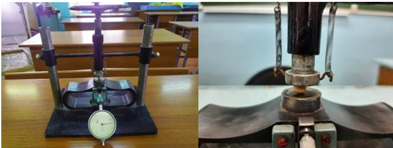
Рисунок 2. Тензометрическая установка для изучения механических свойств сельскохозяйственных культур
